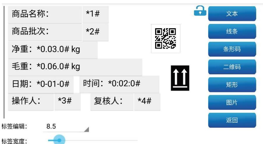
图上“\*1#-#4#”代表可以变动调取的参数，编辑完成点击保存。然电子秤上按下下限键开机或者称重界面下长按【累计打印】，出现P00000, 手机编辑软件
